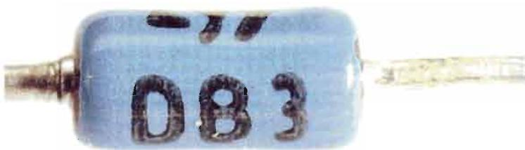
**Il DIAC, potendo condurre corrente in entrambi i sensi, non è polarizzato.** Significa che, come, nel caso del resistore, non esiste all'esterno del componente alcun riferimento per il suo montaggio in un circuito. Per questa ragione i suoi due terminali non hanno, come nel caso dell' SCR, nomi.
