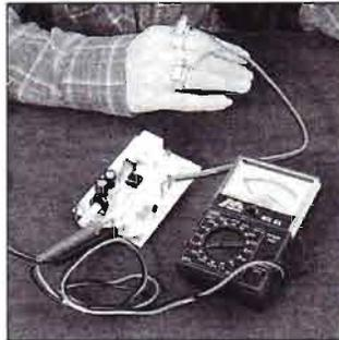
**La macchina della verità** fornisce un'indicazione sullo stato emotivo di una persona basandosi sull'esame di resistività della pelle, che cambia in funzione della sudorazione cutanea.
