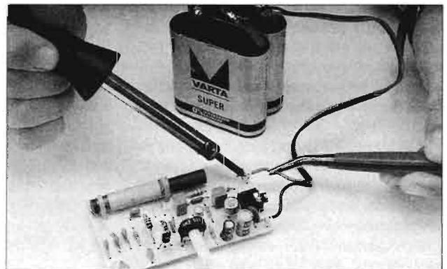
**La regolazione di sintonia si effettua inserendo o sfilando il nucleo in ferrite dalle bobine. L'operazione si deve eseguire molto lentamente.**
