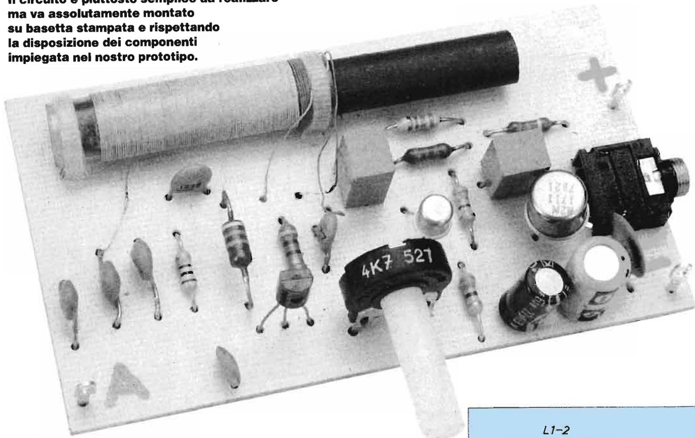
**Regolazione (manuale) del nucleo in ferrite della bobina d'ingresso in corrispondenza dei limiti delle frequenze da ricevere: in A (nucleo tutto estratto), si sintonizza la parte più alta delle O.M. (fino a 2 MHz), in B (nucleo tutto inserito) la parte più bassa (fino a 400 kHz).**
